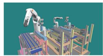
WINCAPS Plusで共有する3Dビューワーです。強化された3D CADデータの読み込み、オブジェクトの動作環境、オブジェクトの管理により、WINCAPS Plusの製品群に快適なシミュレーション環境を提供します。
