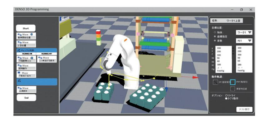
ロボットの軌道上にフロー制御文 (条件分岐) などのコマンドを埋め込むことで 視覚的にロボットの動きを把握しながらプログラミングができるため、 プログラム言語に慣れていないユーザーでも簡単にプログラムができます。
