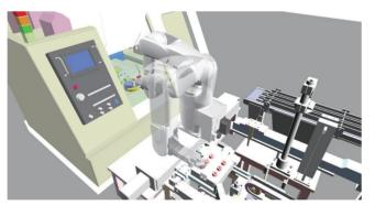
ロボット動作の開始地点・終了地点を指定すると、障害物を回避し、サイクルタイムの最も短い経路を自動生成します。これまでユーザーの経験に頼っていたロボットの経路設計を科学的に生成できるため、熟練者でも初心者でも同じパフォーマンスでロボットを動かすことができます。
