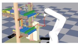
自動運転中にロボットが通った経路には 動作の妨げになるものはなく、安全であると 仮定して、自動収集した動作経路から安全に 原点に戻ることができる経路を生成します。 部分的な動作の逆再生も可能です。
