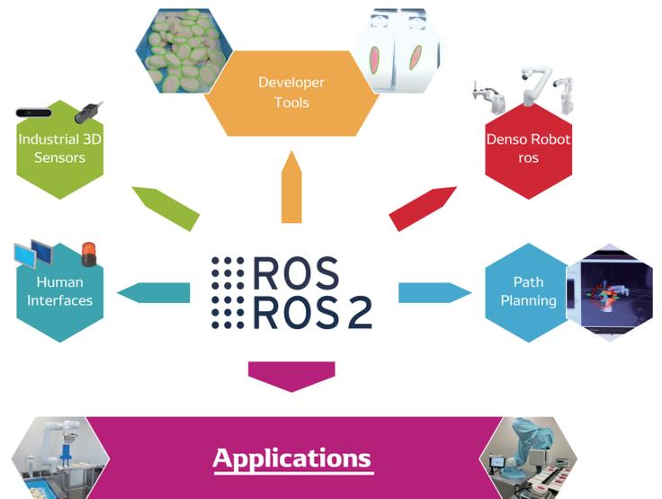
ROSとは、ロボットシステム開発ツールやライブラリが含まれたオープンソースソフトウェアです。誰でも自由に利用できるため、ロボットシステム開発速度を向上させることができます。デンソーウェブでもロボット用のパッケージを作成して公開しています。
