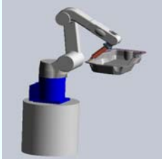
オイルパンのシーリング
