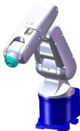
ミニ垂直多関節ロボットVPシリーズは、小型・軽量(わずか14kg)で、持ち運び、据付けも容易で、工場のレイアウト変更にも柔軟に対応。設置面積は、わずか160X160mm、コンパクトながら、最大リーチは約430mmと、広い動作エリアを確保します。
