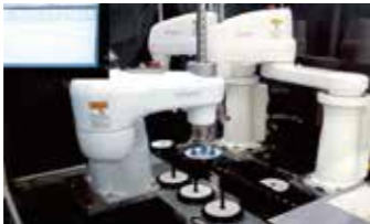
複数台ロボット最適経路計画による “ぶつからない”高速ワーク整理
