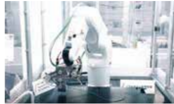
電子カムを活用した ケーブルの配線作業の自動化
