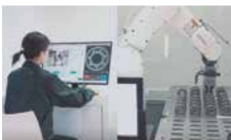
ロボット遠隔操作サービスを活用した 外観検査システム
