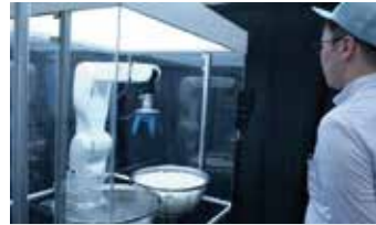
音声認識機能による 直接ロボット制御
