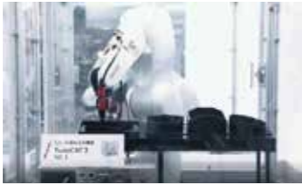
Gコードからの直接ロボット制御
