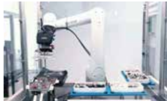
AI搭載の3DビジョンCambrianによる 小サイズ・透明・光沢ワークピッキング
