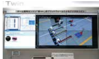
ゲームエンジン「Unity」を活用した ロボットシステムのデジタルツイン (シミュレーション)
