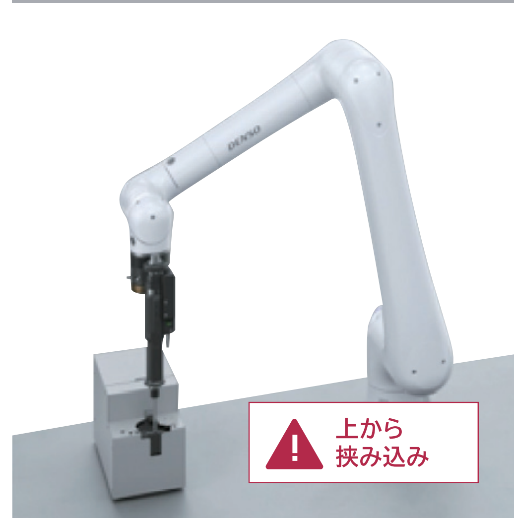
シーン1 ボルト取り出し
