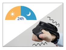
徹底した省電力設計により、頻度の高い作業でも、丸一日、連続使用が可能。 バイブレータを搭載し、騒音の多い現場でも、快適な作業性。
