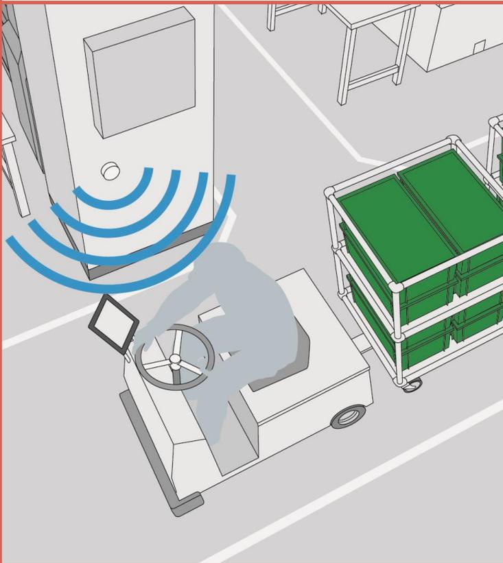
部品運搬ルート上にBeaconを配置し、車両の位置情報を自動収集
