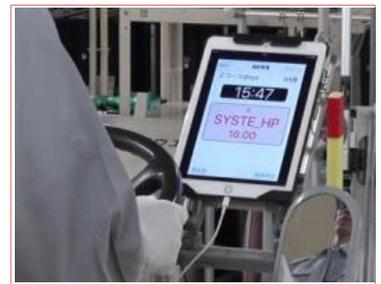
部品運搬車両に取り付けたタブレットに運搬指示を表示。
