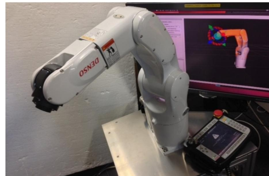
ROSに対応した産業ロボット向けオープンソースロボットコントローラ。展示ではROSの軌道計画アプリケーションMoveIt!を利用しています。
