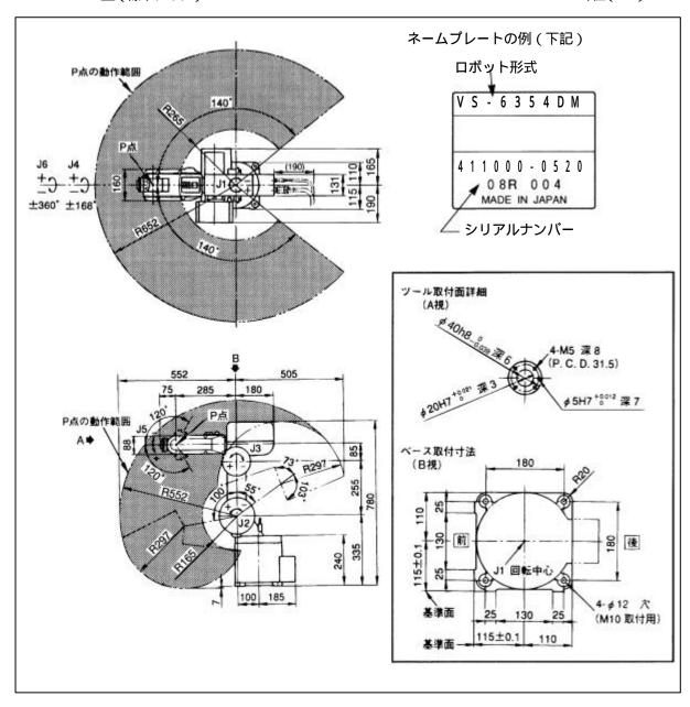
外形寸法と動作範囲 VS-6354D-W型(防塵防滴タイプ)
