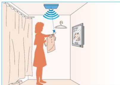
通信距離約2.6mで試着室の天井
