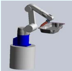
オイルパンのシーリング
